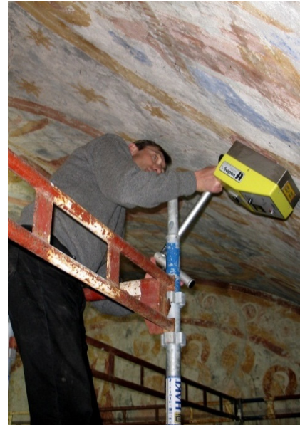
Ph.D. Poul Klenz Larsen från Nationalmuseet i Danmark under mätning av murverksfukt.
